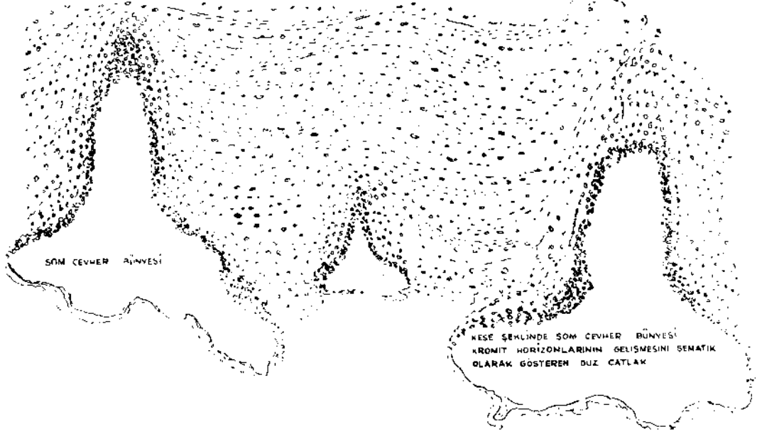
Şek. 8- Takriben 50° nin üzerinde olan dik eğimin tezahürü şarttır. Vertikal dimansiyonlar umumiyetle yüzlerce metreye balığ olmaktadır
