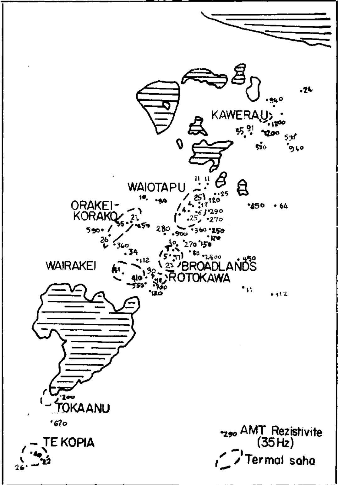
Şek. 5 - Kuzey Yeni Zelanda adasının merkezî volkanik kısmı içinde audio-frequency magneto-telluric metotla ölçülmüş rezistivite değerleri.
