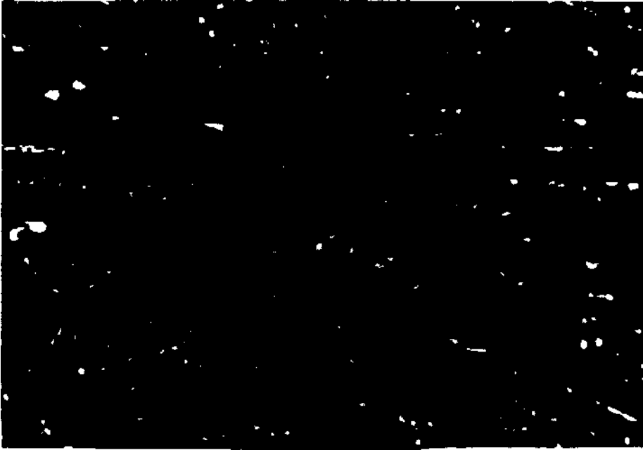
Şek. 5 - Kristalografik istikametlere göre sıralanmış olan kalkopirit eksollüsyon kapanımları (beyaz) ihtiva eden çinkoblend tanesi (X 260). Yeri: Kutonit.
