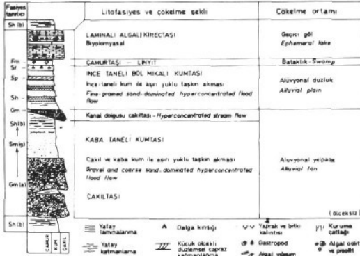
Şek. 12- Tortul fasiyelerin istif içindeki genelleştirilmiş düşey dağılımı, çökme şekli ve yansıttığı ana çökme ortamları.
