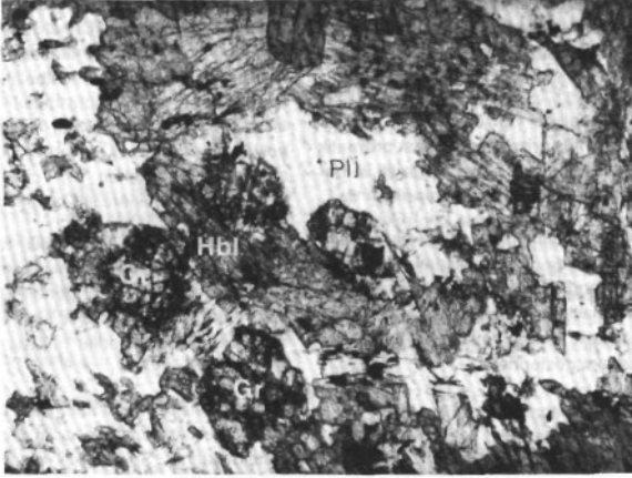
Şek. 4- Granat amfibolit. Gr: Granat; Hbl: Hornblend; Plj: Plajiyoklaz. Büyütme: 63, 1 ek nikol.
