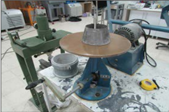
Şekil 7- İşlenebilirlik deneyi aparatları.
