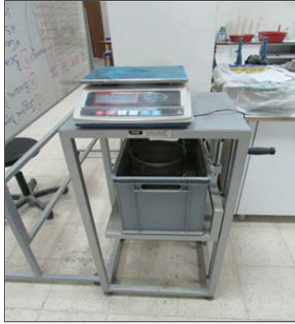
Şekil 8- Yığın yoğunluk deneyleri test düzeneği.
