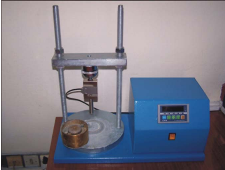
Şekil 1- Sabit hacimli şişme deney düzeneği.
