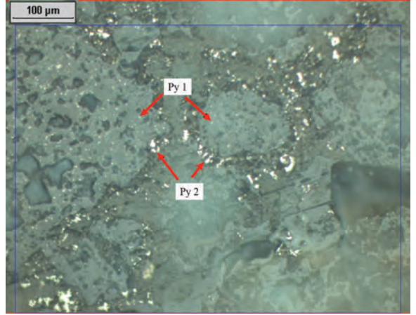
Şekil 5- İki farklı gang, iki farklı pirit. Açık gri renkli gang içindeki küçük taneli "Pirit 1" ve koyu gri renkli gang içindeki Pirit 1'den daha iri ve bol "Pirit 2". Pirit 2'li gang diğerini çepeçevre sarıyor.
