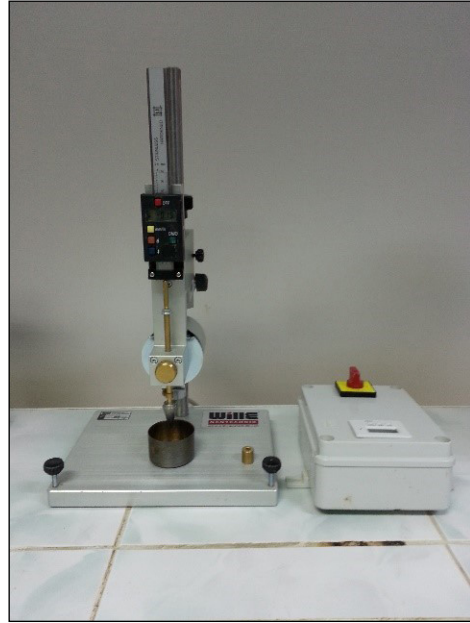
Şekil 2- Bu çalışmada kullanılan düşen koni cihazı.
