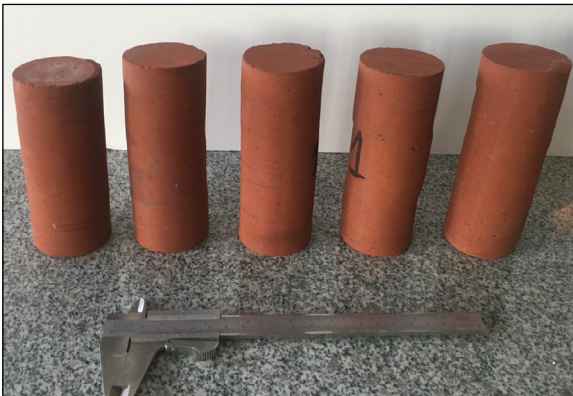
Şekil 2- Tuğla karotlarından bir görünüm.
