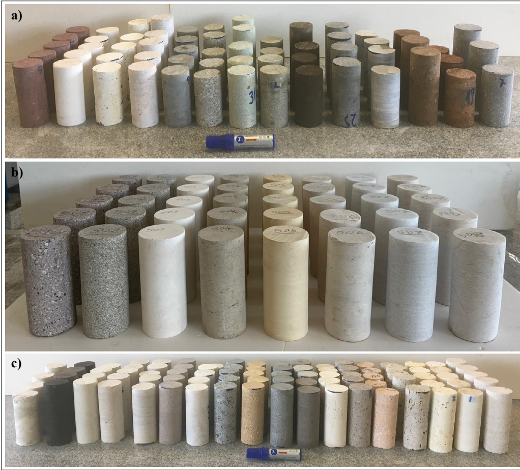
Şekil 7- Farklı kaya türlerinden alınan karot örnekleri.
