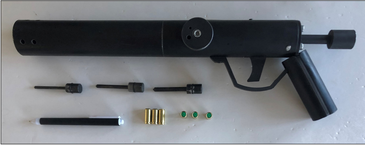
Şekil 1- Araştırmada kullanılan çivi tabancası, üç farklı çaptaki çiviler ve ses kurşunları.
