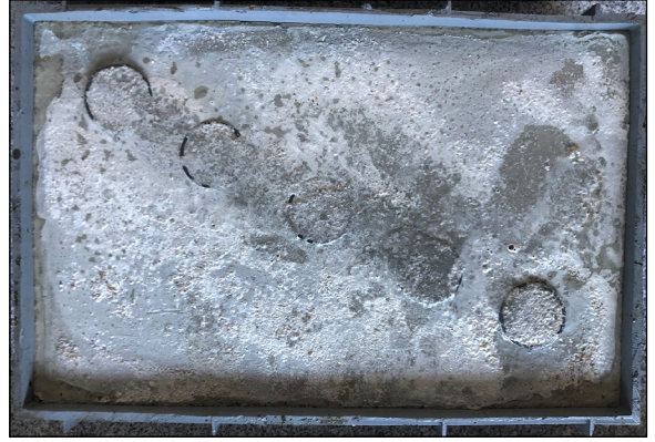
Şekil 4- Dökme beton ve beton içine gömülmüş silindirik silindirik numune kapları.
