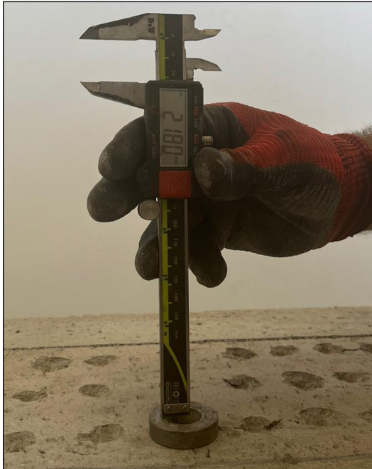
Şekil 8- Bir çivinin kayaya saplanmadığı durumlarda çivi penetrasyon derinliğinin ölçümü.
