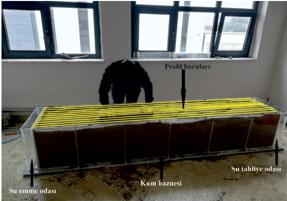
Şekil 2- Tankın üç haznesini ve profil çizgilerini (sarı çizgiler) gösteren pleksiglas tankın görüntüsü.
