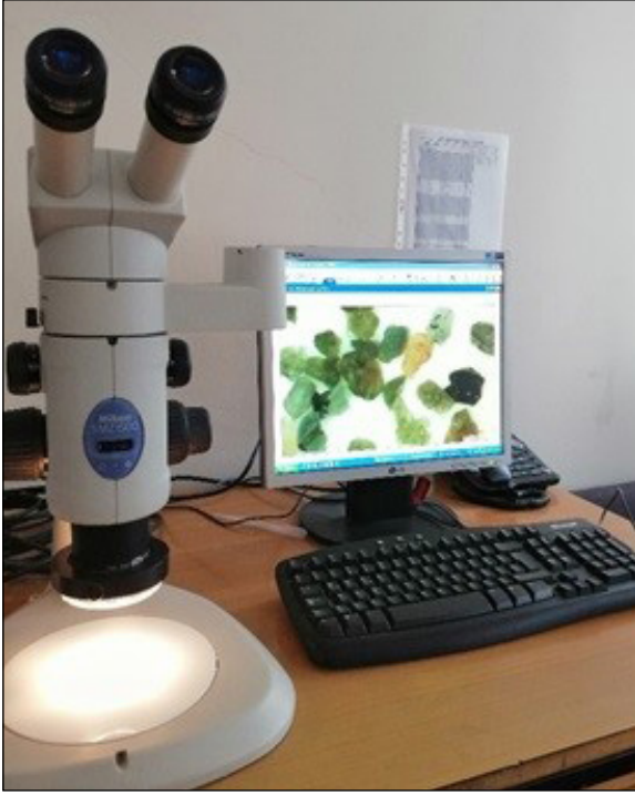
Şekil 3- Stereo mikroskop ve imaj analiz yazılımı..
